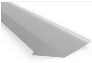
10. RÄNNDALSPLÅT, RAK Plåten mellan olika takhalvor (230x230)
